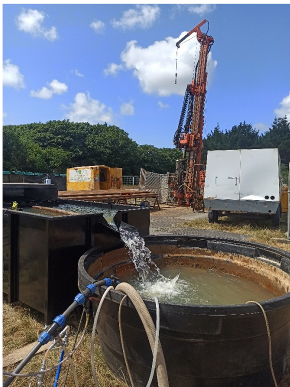
Фото: Гідравлічні випробування та хімічний моніторинг на майданчику United Downs, червень 2023 року. Ліворуч: бурова установка біля свердловини GWDD001 на фоні та рідина, отримана під час випробувань методом аероліфта, на передньому плані. Праворуч: хімічний моніторинг відібраної рідини під час трасерних випробувань на свердловині GWDD002. На передньому плані – проточна комірка для вимірювання pH, температури, окисно-відновного потенціалу, електропровідності та вмісту розчиненого кисню.
