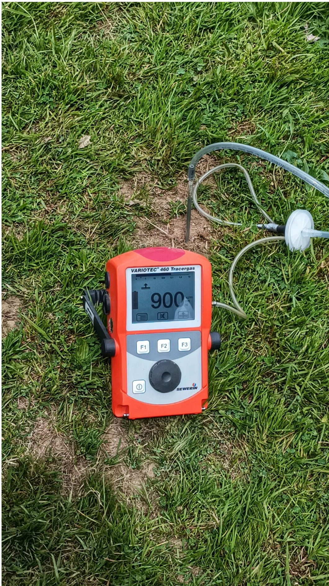
Газоналізатор Варіотек 460 Трейсергаз для вимірів концентрації водню в ґрунті
